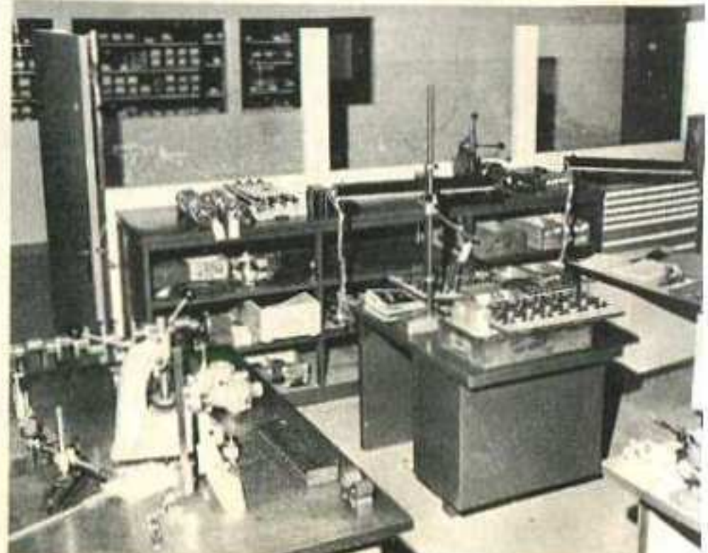
Il reparto montaggio motori. Tutte le parti provengono da officine esterne, ma sono progettate alla Matra. Sotto: ogni pezzo che arriva dai fornitori esterni è collaudato e controllato accuratamente prima di essere passato nel magazzino dove per ogni tipo di motore c'è un apposito compartimento separato
