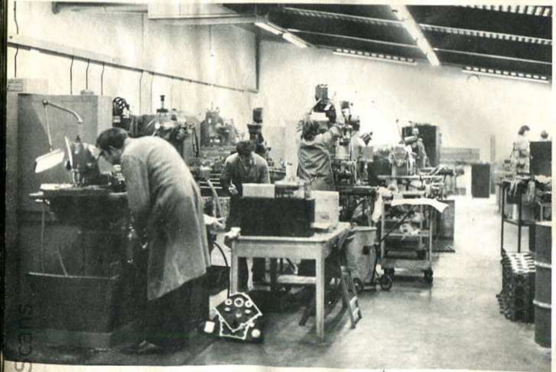
Il reparto delle lavorazioni meccaniche. In primo piano in basso ecco un carter della distribuzione, appena uscito dalla fresatrice
