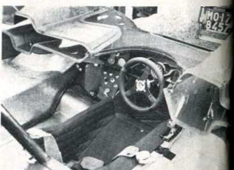
In alto, al centro della foto, una delle due travi a traliccio chiodato che portano « appeso » il 12 cilindri piatto. Sulla coda i radiatori olio. Sopra, una vista dell'abitacolo, con il pannello di servizio sulla sinistra del pilota
