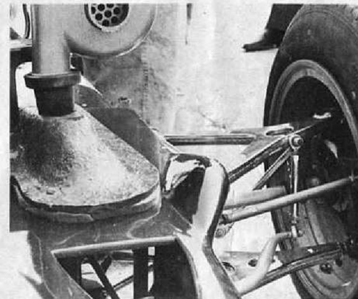
La sensazione di estrema leggerezza della Lotus 72 risulta in pieno da questa foto della sospensione anteriore in cui sono visibili sia l'alberino di collegamento fra ruota e freno, sia la sottile astina che unisce l'assieme oscillante al braccio di torsione. Sono in funzione i ventilatori dei dischi freno
